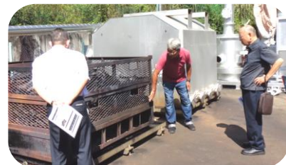
中央、銀色の設備が製炭炉。その左側が製炭後の竹廃材。土釜に比べ炭化時間が大幅に短縮される。人物中央が島田所長。
